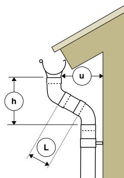
Длины из расчета угла промежуточной части 70° относительно вертикальной оси.
