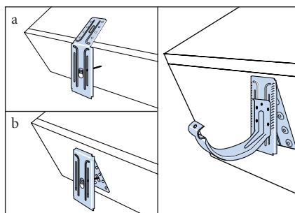
Использование компактного кронштейна с регулировочной плитой Cb2 исключает необходимость изгиба конструкций крепления. Они могут быть закреплены непосредственно на краю крыши или на лобовой доске с наклоном 8-45°.
