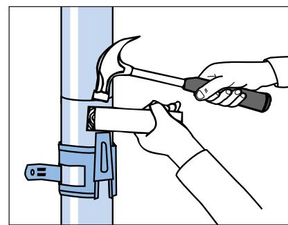
Проверьте вертикальность водосточной трубы и установите шпонку хомута (см. рис.).
