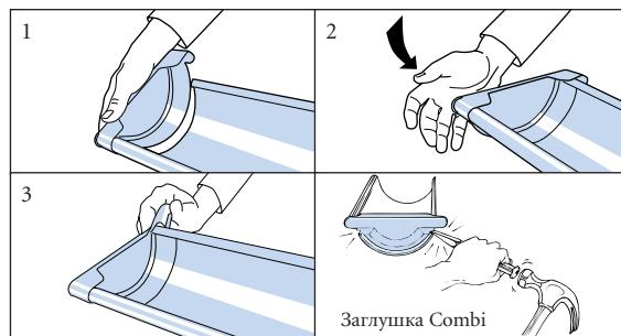
Установите заглушку UNI в желоб (1). Прибейте ее (2). Разорвите заднюю штампованный часть заглушки и загните металлические полосы на углах (3).
