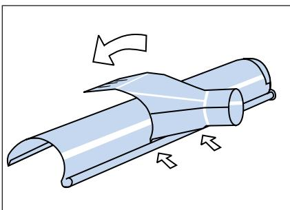
Установите воронку на нижней стороне полукруглого желоба. Толкните воронку вверх до края и фиксируйте на месте с помощью заклепок. Борт наружу!
