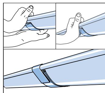
Используйте соединители Plannja Siba для присоединения отрезков желоба (см. рис.). Установите концы желобов друг напротив друга, поместите задний край соединителя вокруг задних краев желобов и защелкните фиксатор (см. рис.).
