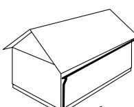
Определите площадь крыши и соответствующие размеры согласно таблице. При расчете количества водосточных труб на 10 м крыши должно приходиться по одной трубе.
