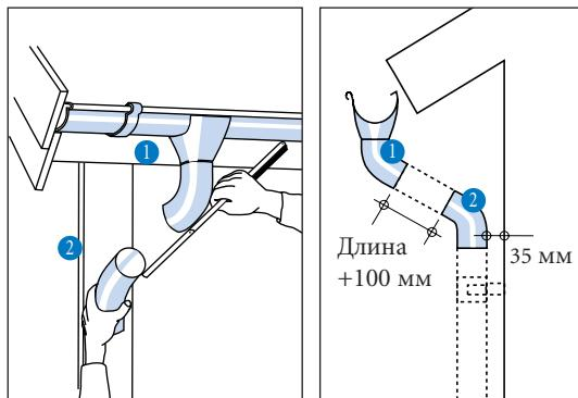
Длина соединяющего элемента зависит от выступа кровли.
