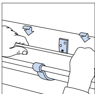
Если Вы используете самоблокирующиеся или компактные кронштейны, желоб фиксируется на месте автоматически.
