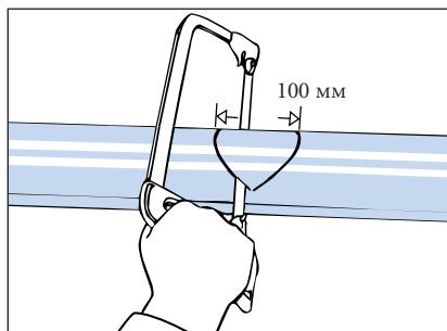
Водосточные трубы должны укладываться на расстоянии 150 мм от концов желоба. Вырежьте в желобе отверстие (100 мм), как показано на рисунке.
