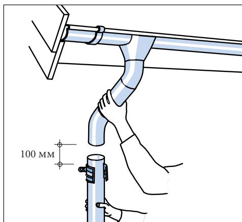
Имеются хомуты для каменных и деревянных стен. Установите верхний хомут непосредственно под коленом. Рекомендуемый интервал между хомутами – 2 метра.
