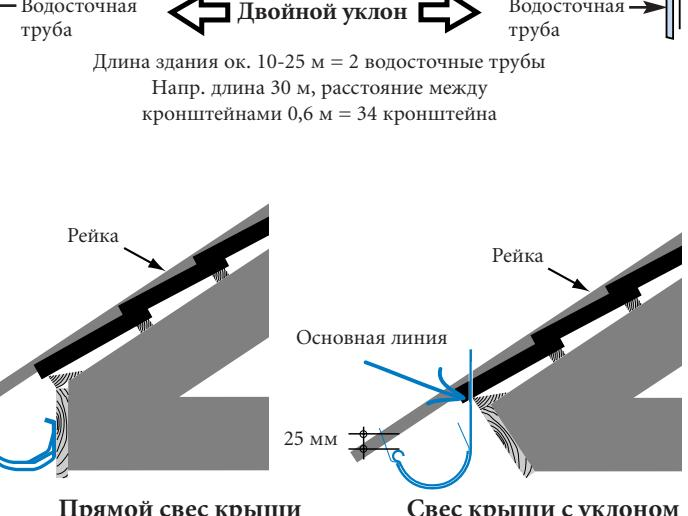
Прямой свес крыши Свес крыши с уклоном
