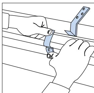
Положите желоб на кронштейны и отрежьте желаемую длину. Надавите желоб вниз на кронштейны и фиксируйте на своем месте с помощью заклпок.
