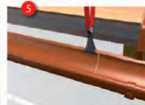
Загните ребра желоба. При правильном склеивании, клей должен выступить.
