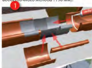
Установите температурный компенсатор расширения желоба (соединение клеим или заклепками). Температурный компенсатор рекомендуется устанавливать, если длина желоба превышает 12 метров.
