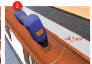
Просверлите отверстие для заклепки, \varnothing 4,1 мм.
