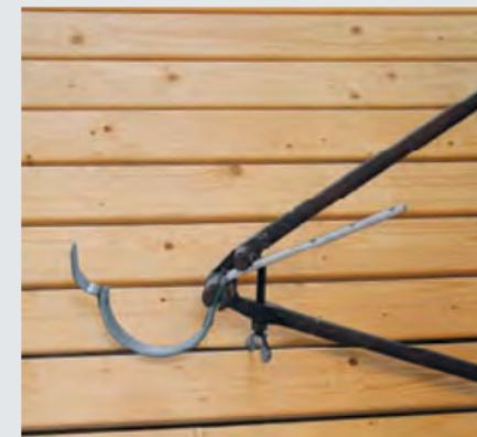
Разметка линиигиба нижнего крюка. При 3-х метровом желобе, получается:  $3\text{ м} \times 3\text{ мм}/\text{м} = 9\text{ мм}$  перепад высоты.
